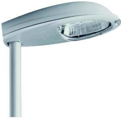
Armatura stradale tipo IRIDIUM SGS253 con telaio in pressofusione di alluminio e carenatura in poliestere con fibra di vetro. Riflettore in alluminio purissimo. Atta al montaggio testa palo (60-76 mm) o sbraccio (34-60 mm) tramite sistema integrato. - SON-T - 100 W - Open CT-POT - Vetro piano FG
